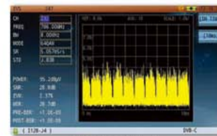
Análisis EVS muestra interferencia.
