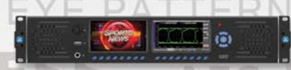
Phabrix Rx2000 – Rasterizador y Generador para 3G/HD/SD SDI
